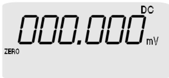
L'appareil confirme le réglage du zéro par un signal sonore et l'écran affiche la valeur "000.000" ( $\pm 1$  digit) et le symbole "ZERO". La tension affichée au moment de la pression sur la touche sert de valeur de référence ( $\pm 20000$  digits maximum). Elle est automatiquement soustraite aux valeurs mesurées par la suite.
