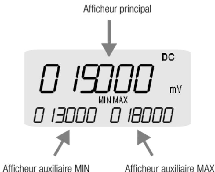
Alors que l'afficheur principal est activé dès que le multimètre est allumé, il faut activer les deux afficheurs auxiliaires en appuyant sur la touche DATA/CLEAR. Cela évite qu'un
