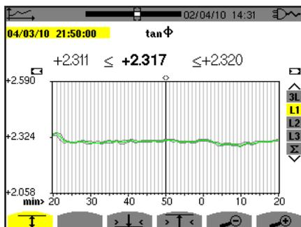
Figure 86 :  $\tan \Phi$  (L1) avec MIN-AVG-MAX
