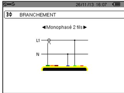
Figure 12 : Connexion en monophasé 2 fils
