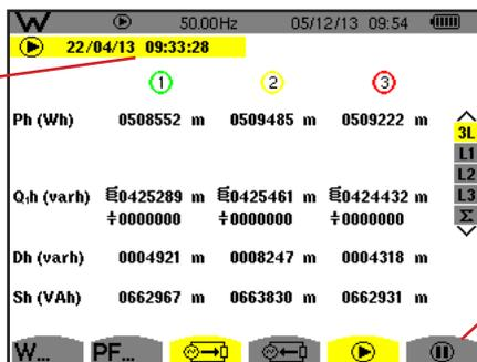
Figure 105 : L'écran de démarrage du comptage d'énergie en Wh
