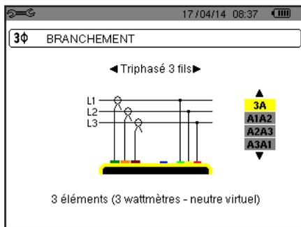
Figure 14 : Connexion en triphasé 3 fils
