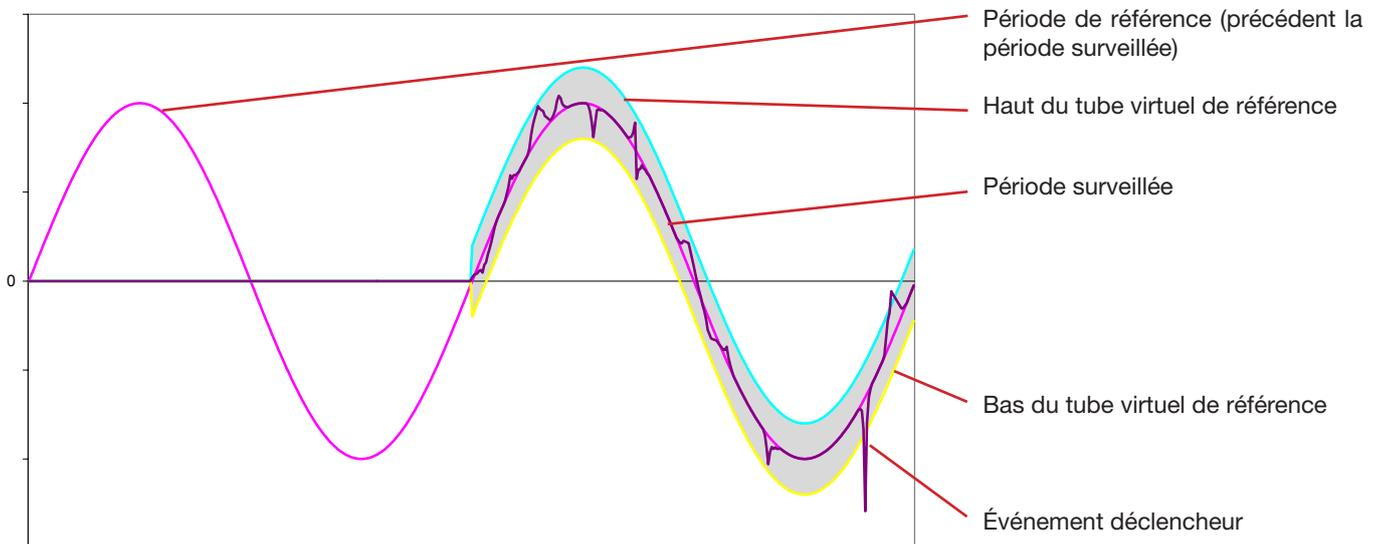
La demi-largeur du tube virtuel pour la tension et le courant est égale au seuil programmé dans le mode Transitoire de la configuration (voir § 4.8).
