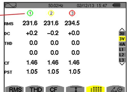
Figure 68 : L'écran affichage simultané en 3V
