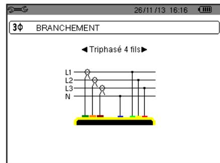
Figure 15 : Connexion en triphasé 4 fils
