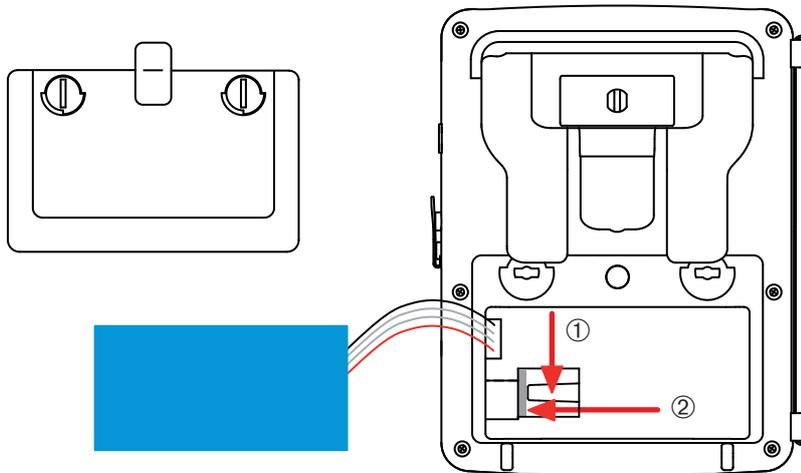
Pour remettre la carte en place, glissez-la horizontalement dans son logement jusqu'à ce qu'elle soit complètement enfoncée et que la languette se remette à sa place.
