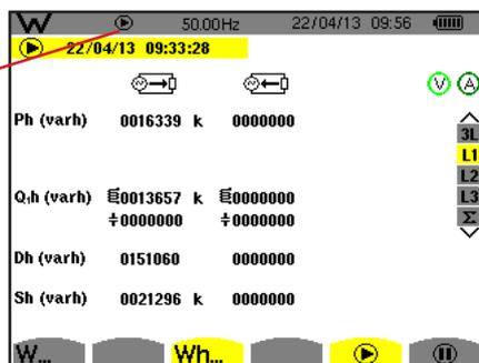
Figure 106 : L'écran de comptage d'énergie en varh
