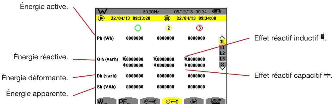
Figure 100 : L'écran d'affichage des énergies générées en 3L
