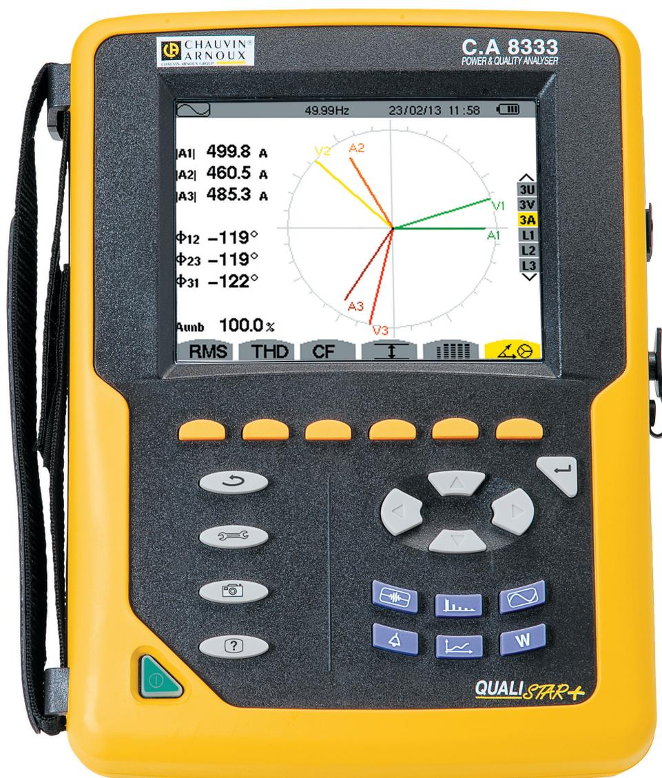
**Analyseur de réseaux électriques triphasés**
