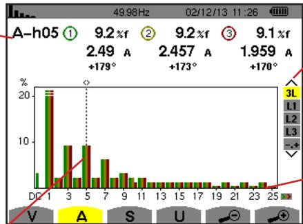
Affichage des 3 phases 3L, de L1, L2, L3 ou (pour le C.A 8333 uniquement) du mode expert (branchement triphasé uniquement - voir § 6.5). Pour sélectionner l'affichage, appuyez sur les touches ▲ ou ▼.
