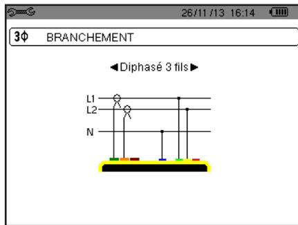
Figure 13 : Connexion en diphasé 3 fils
