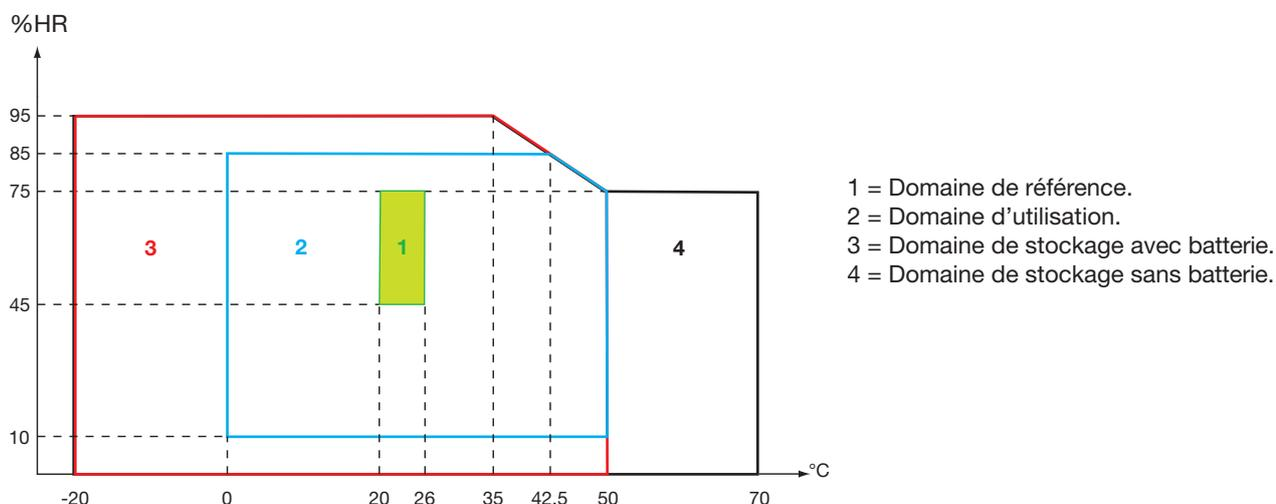
**Attention :** au delà de 40 °C l'utilisation de l'appareil doit se faire sur la batterie seule **OU** sur le bloc secteur seul. L'utilisation de l'appareil avec simultanément la batterie **ET** le bloc secteur externe spécifique est **interdite**.
