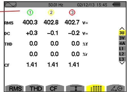
Figure 67 : L'écran affichage simultané en 3U
