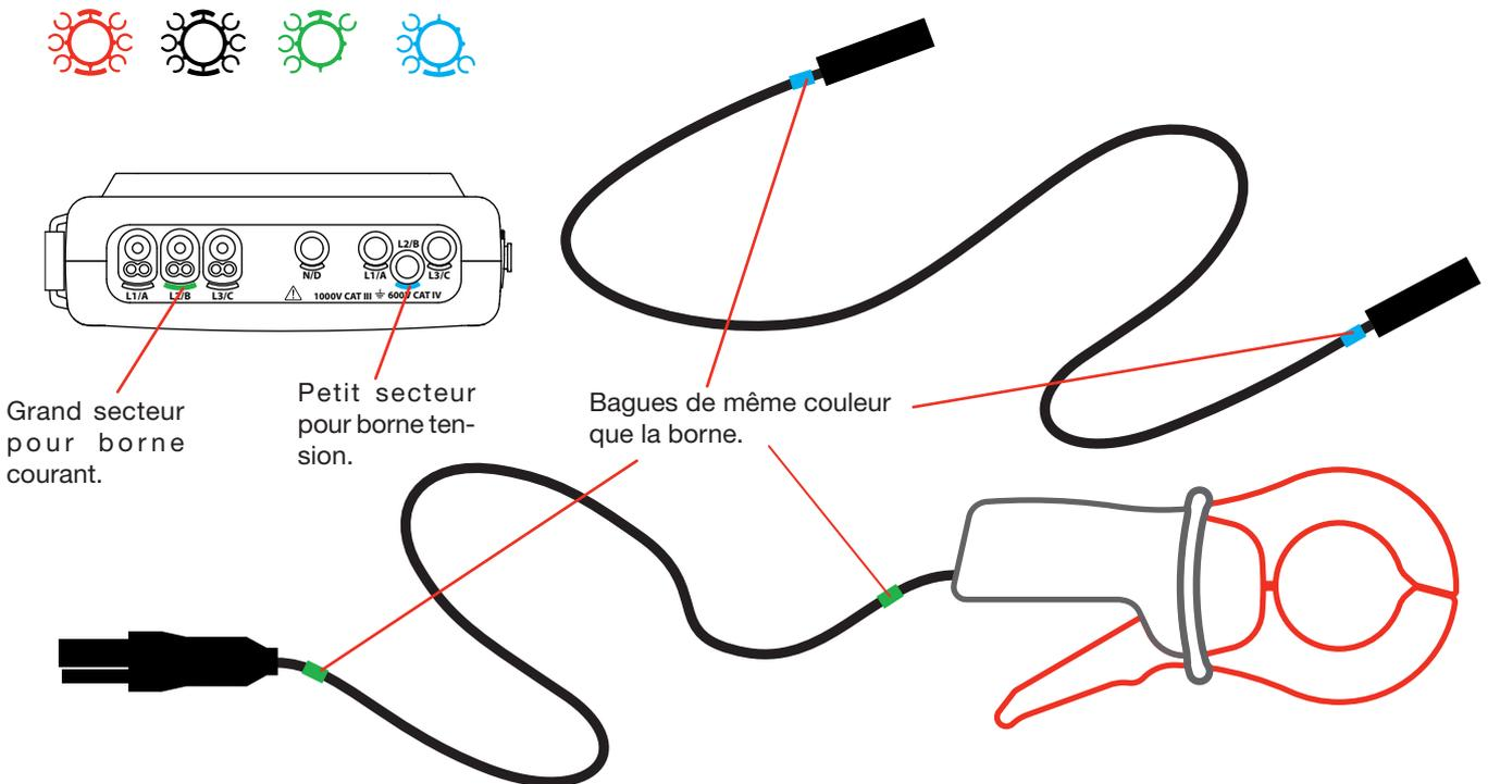
Figure 10 : Identification des cordons et des bornes
