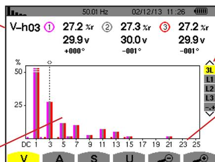
Affichage des 3 phases 3L, de L1, L2, L3, N ou (pour le C.A 8333 uniquement) du mode expert (branchement triphasé uniquement - voir § 6.5). Pour sélectionner l'affichage, appuyez sur les touches ▲ ou ▼.
